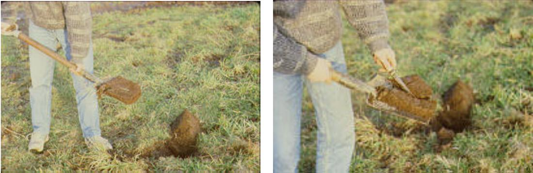
Fig. 2. Muestreo con pala recta
