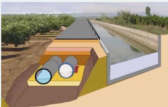
Esquema virtual del Canal antiguo y la nueva Red a presión de la Acequia Real del Júcar.
